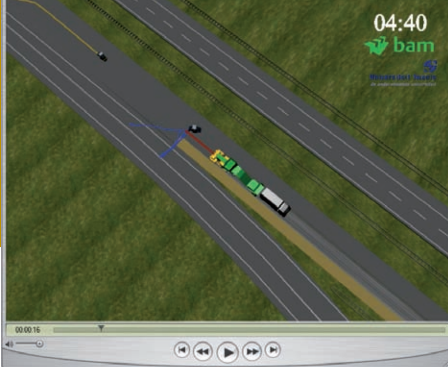
Figuur 8: Simulatie van het uitvoeringsproces (wals, asfaltspreader, shuttle buggy en truck)
