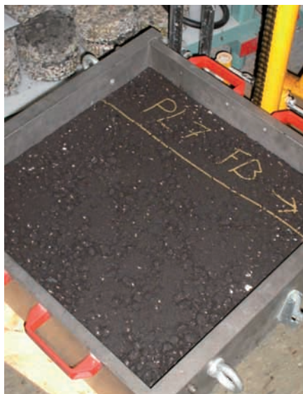
Resultaat verdichte plaat
