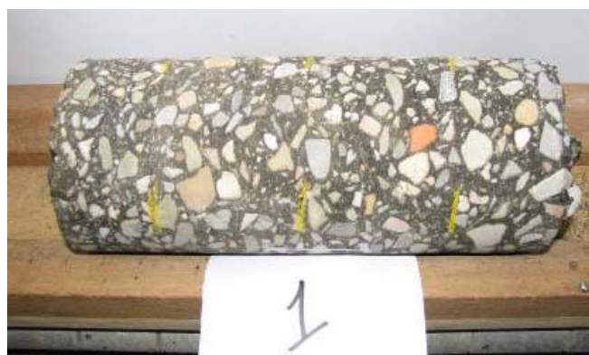
Foto: Een boorkern voor laboratoriumonderzoek
