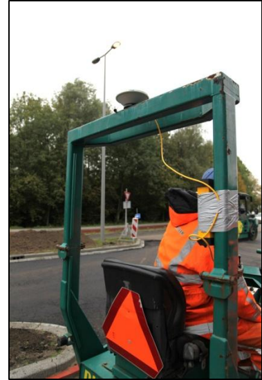
Figuur 3: De opening van het project Noorderlijke Randweg Rotterdam (links) en een GPS tracker gemonteerd op een walsmachine (rechts).
